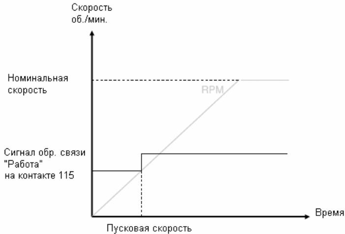
График иллюстрирует активацию дискретного входа сигнала обратной связи (контактный зажим 117) в момент достижения двигателем скорости зажигания.
